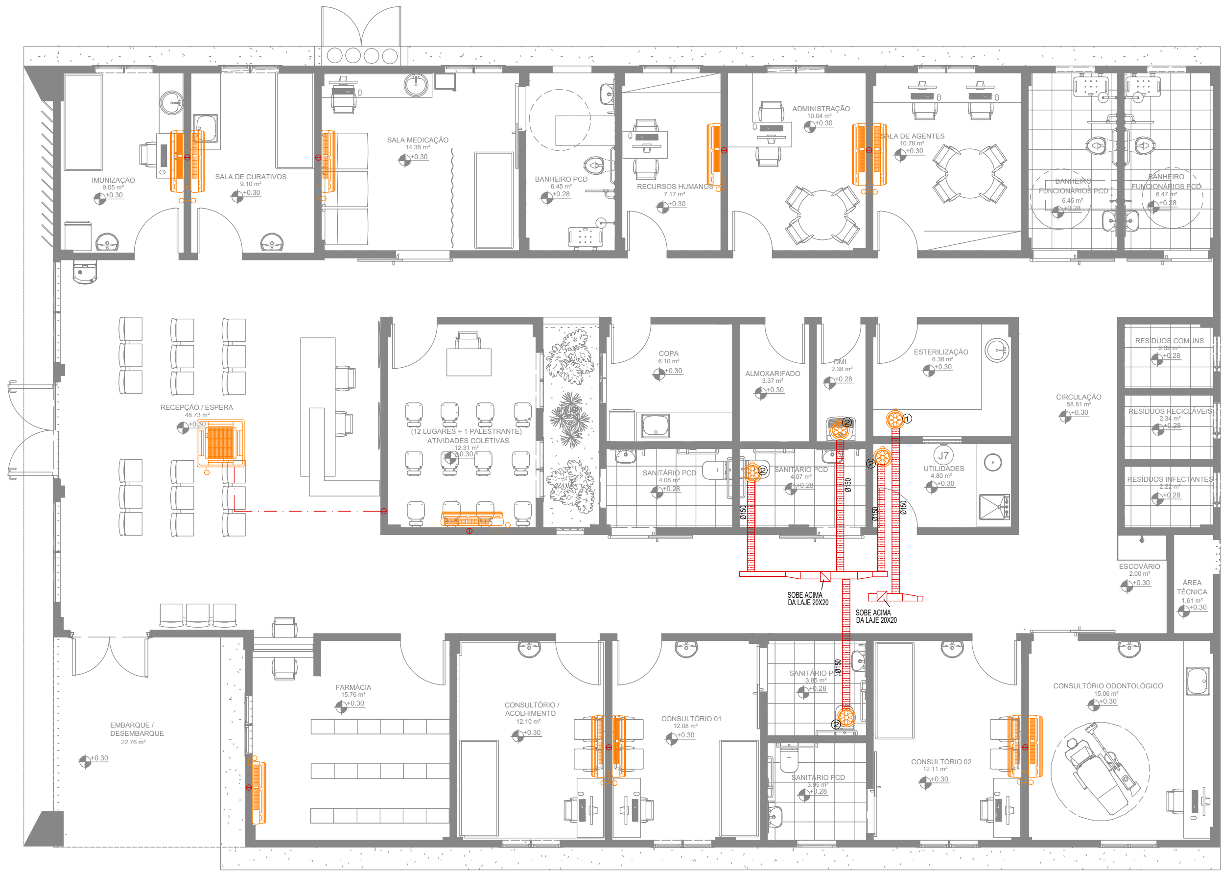
PLANTA BAIXA - CLIMATIZAÇÃO ESC. 1/75
